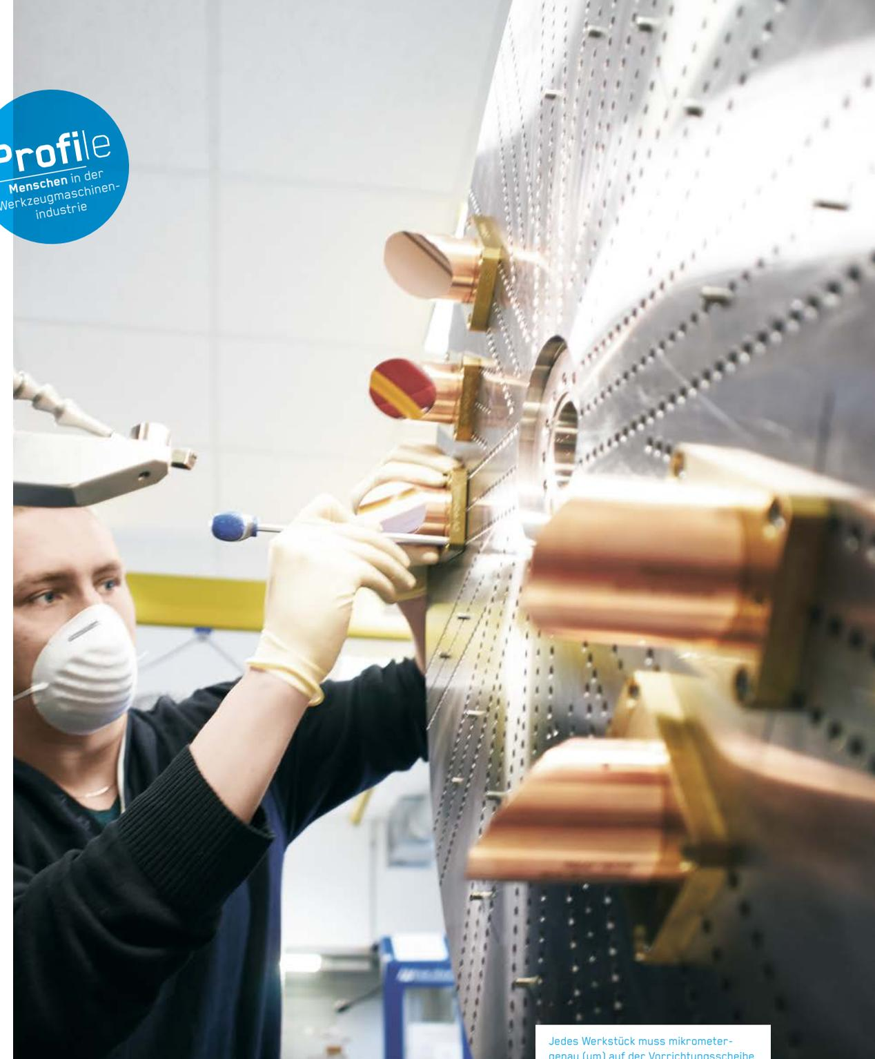
Jedes Werkstück muss mikrometergenau ( $\mu\text{m}$ ) auf der Vorrichtungsscheibe befestigt werden. Eine luftgelagerte Spindel dreht sie dann mit 400 bis 600 Umdrehungen pro Minute ( $\text{min}^{-1}$ ).
