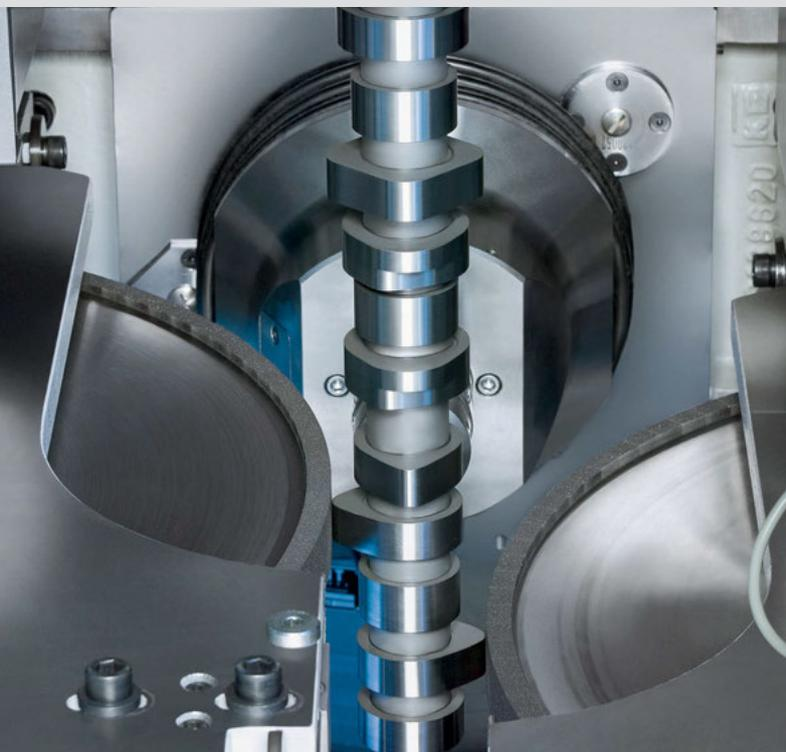
Unrundbearbeitung einer Nockenwelle durch Simultanschleifen auf einer vertikalen Schleifmaschine
