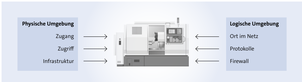
Abb. 9: Physische und logische Umgebung der Maschine
