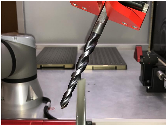
((5_AT-Robotics_Schneidkantenverrundung der Fase an Stufenbohrer.jpg))
